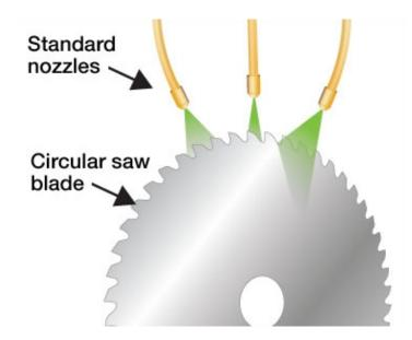
Fig. 174: Saw blade lube system
